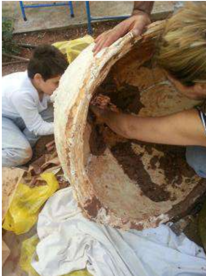
Αφαίρεση πηλού από το εσωτερικό του καλουπιού
