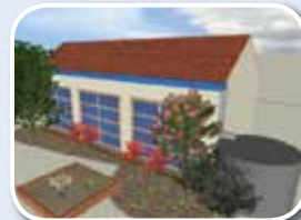
Συγκέντρωση νερού από τη στέγη σε δεξαμενή αποθήκευσης και διοχέτευση του στις φυτεμένες περιοχές.
