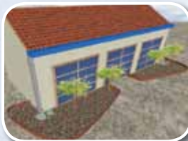
Δημιουργία κλίσης στη στέγη για απευθείας συγκέντρωση του νερού στις φυτεμένες περιοχές.
