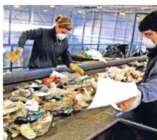
Εικόνα 33. Διαχωρισμός απορριμμάτων στην μονάδα επεξεργασίας (Πηγή: Πολίτης 2015).
