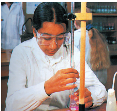
Η συγκέντρωση του αιθανικού οξέος στο ξίδι μπορεί να υπολογιστεί με ογκομέτρηση.
