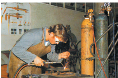
Η καύση του αιθινίου με οξυγόνο χρησιμοποιείται για την κοπή και τη συγκόλληση μετάλλων.
