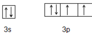
Σχ. 7: Κατανομή των ηλεκτρονίων της εξωτερικής στιβάδας στο άτομο του θείου σε ατομικά τροχιακά, στην θεμελιώδη κατάσταση.
