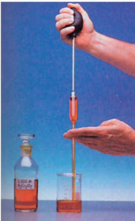
Το σιφόνιο χρησιμοποιείται για μέτρηση όγκου, όταν απαιτείται η ακρίβεια διαλύματος ουσίας, συγκεκριμένης συγκέντρωσης
