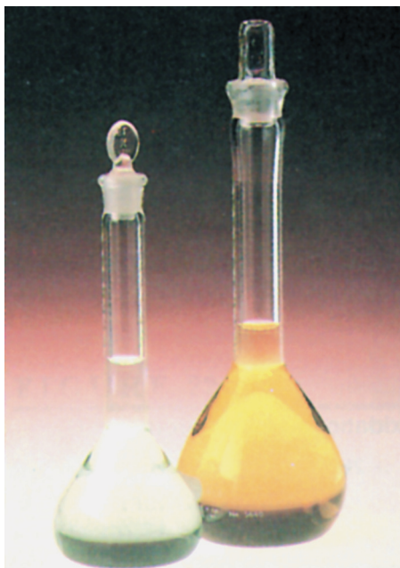
Οι ογκομετρικές φιάλες χρησιμοποιούνται για την παρασκευή διαλυμάτων με συγκέντρωση μεγάλης ακρίβειας
