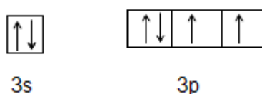
Σχ. 9: Κατανομή των ηλεκτρονίων της εξωτερικής στιβάδας στο άτομο του θείου σε ατομικά τροχιακά, στη θεμελιώδη κατάσταση.
