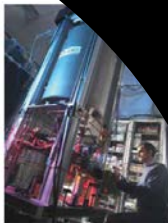
Εικόνα 1.18 Το ιστορικό ρολόι NPL-CJ2 που βρέθηκε στο Εθνικό Εργαστήριο Φυσικής του Ηνωμένου Βασιλείου, θεωρείται το ακριβέστερο ατομικό ρολόι με απόκλισητα 2,3·10 -16 % (© National Physical Laboratory, UK)
