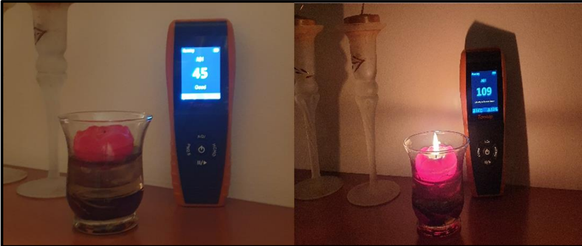
Φωτογραφία 6: Οι διαφορές στις μετρήσεις πριν και μετά το άναμμα αρωματικών κεριών
